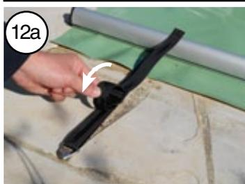
Détendre la partie supérieure de la sangle de sorte d'effectuer une boucle.
