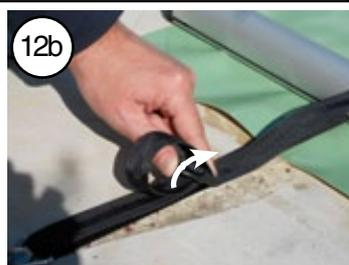
Faire pivoter la boucle Superloc en direction de la couverture, la sangle se détend alors automatiquement.
