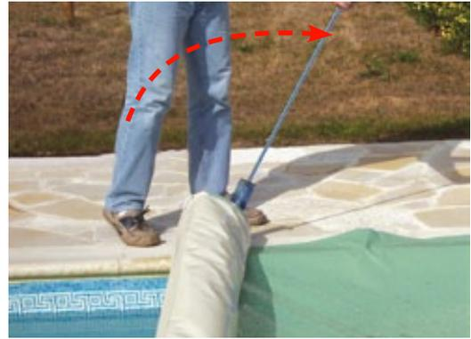
Faire pivoter la manivelle tout en la maintenant fermement et/ou si possible en continuant de manœuvrer, pour aider l'enroulement.
