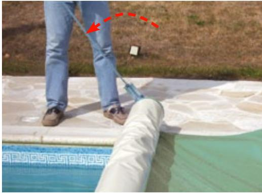
Incliner la manivelle vers la partie non couverte du bassin tout en poursuivant le maniement de la manivelle.
