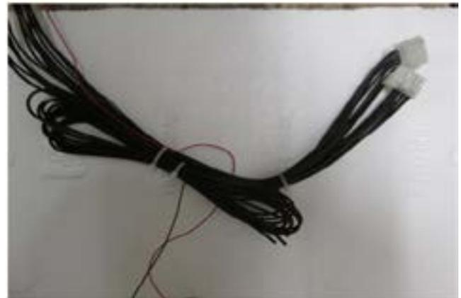
**3.** Utiliser les 3 embouts de fils et les sertir sur les fils 20, 21, 22.
