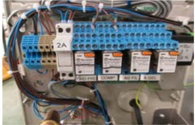
**2.** Sur la partie du faisceau inutilisé, repérer les fils 18, 20, 21, 22, et libérer les fils 20, 21, 22, des colliers rilsans de manière à réaliser le raccordement électrique. Placer de l'adhésif isolant type Chatterton sur l'extrémité du fil 18 (ce fil sert à une autre option).
