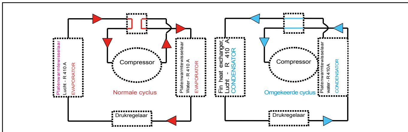
De verdamper en de condensator keren de functies om: de vloeistof voert warmte aan ter hoogte van de platenwarmtewisselaar om het ijs te laten smelten. Tijdens het ontdooien draait de ventilator stationair. Wanneer de temperatuur die door de sensor wordt gedetecteerd stijgt, stopt de ontdooifunctie en herstelt de 4-wegklep de normale cyclus.
