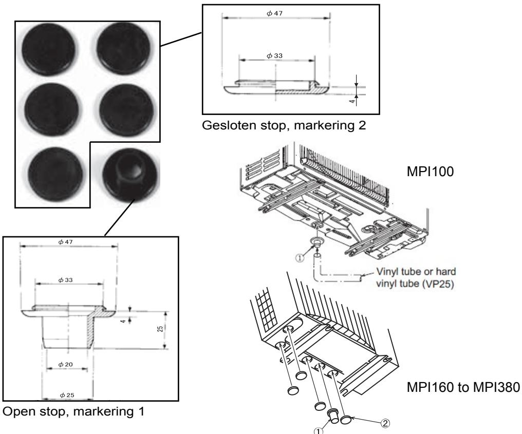
De stoppen worden in de gaten in de voet van het apparaat gestoken, zie onderstaande afbeelding.
