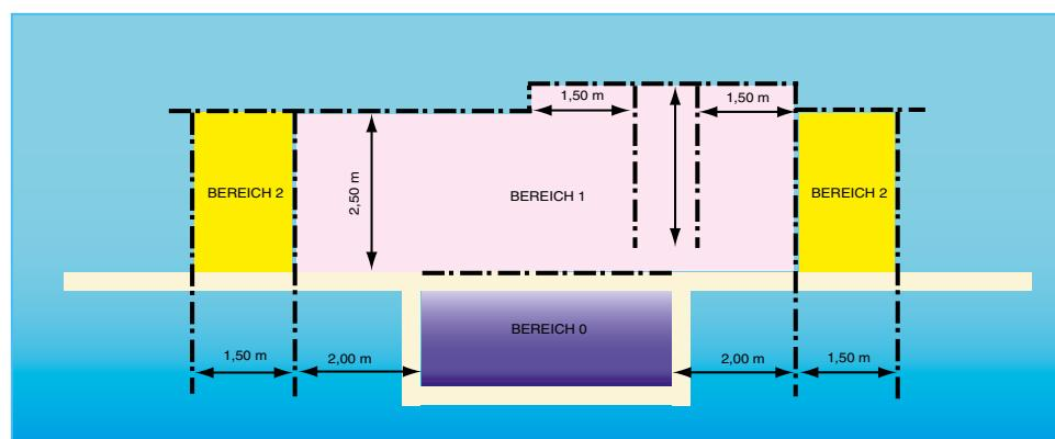
**Bereich 0:** Sicherheits-Kleinspannung\* (SELV) geringer als 12 V wechselnd oder 30 V direkt + Zubehör mit IPX8 Klassifizierung (staubfrei, wasserdicht).
