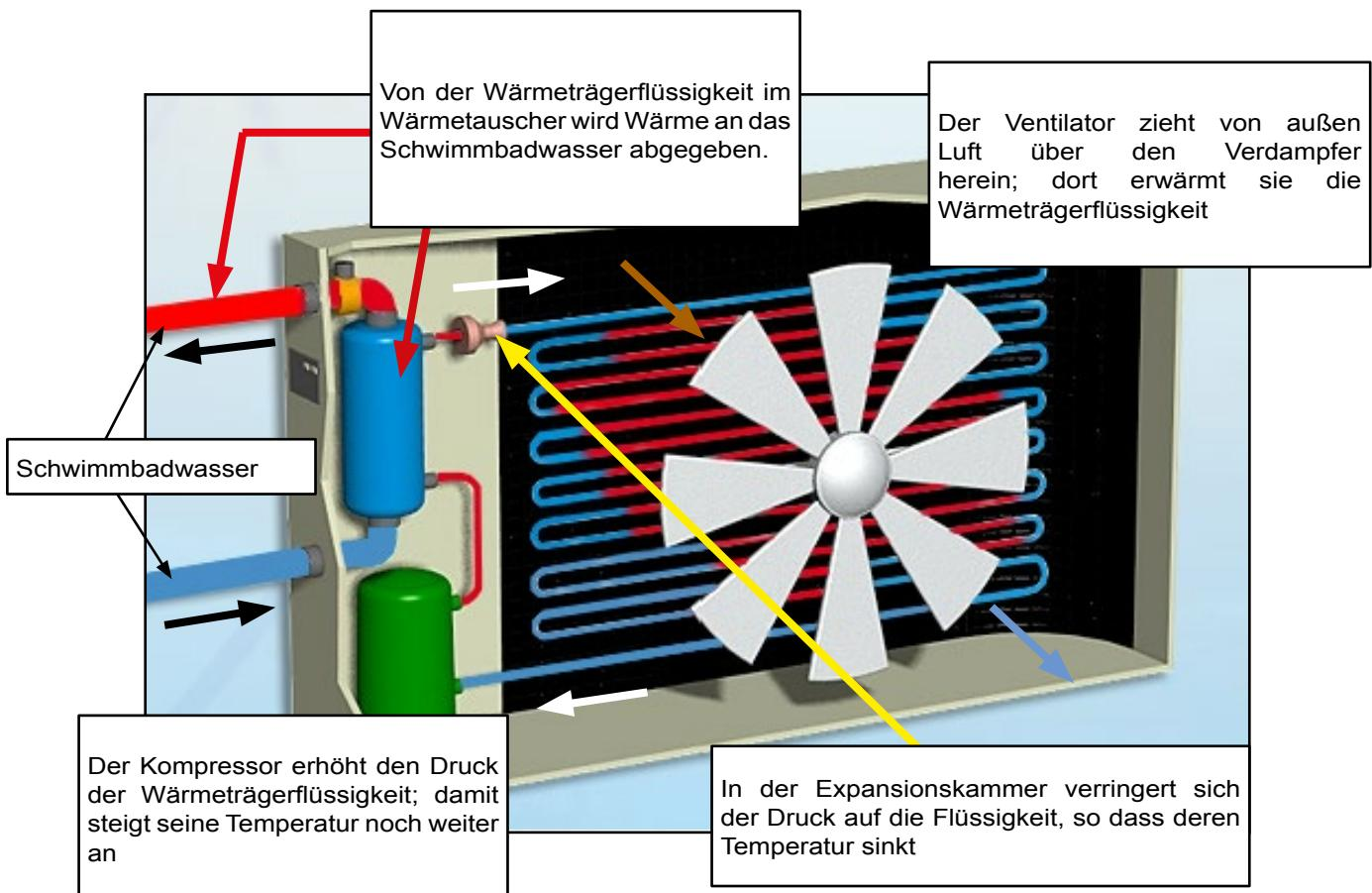
Bei einer Umgebungstemperatur von 15°C können BWT Wärmepumpen vier- bis fünfmal mehr Energie an das Schwimmbadwasser abgeben, als sie selbst verbrauchen (90% der Energie werden vom Kompressor verbraucht). Diese Anlagen haben somit eine Leistungsrate (bzw. Leistungszahl COP) zwischen 4 und 6.
