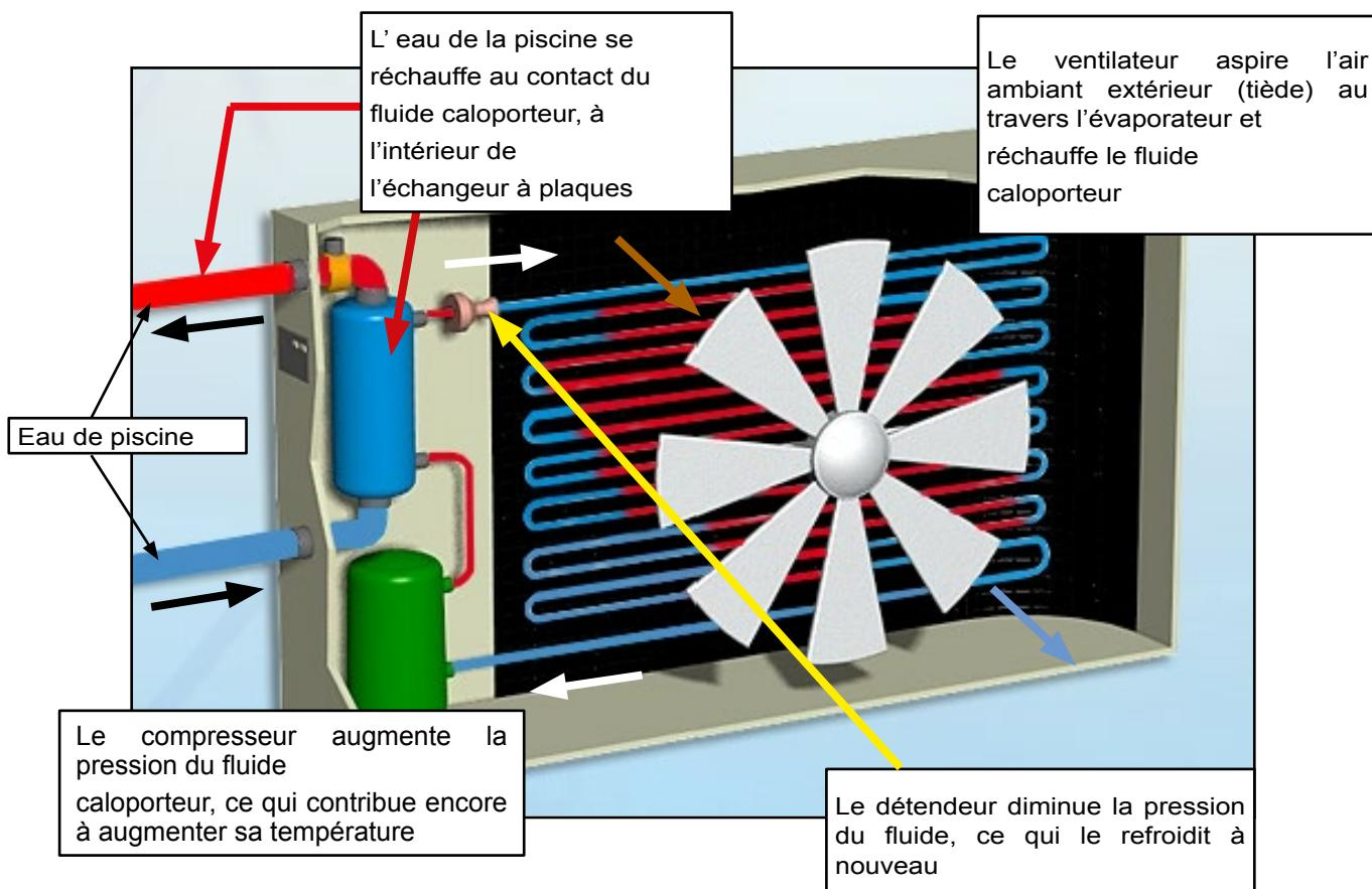
Quand la température de l'air ambiant est de 15°C, les pompes à chaleur BWT communiquent ainsi à l'eau de piscine plus de 4 à 6 fois la quantité d'énergie électrique nécessaire à leur fonctionnement (le compresseur consomme 90% de cette énergie) : ces machines ont un " rendement " (ou COP = Coefficient Of Performance) de 4 à 6.
