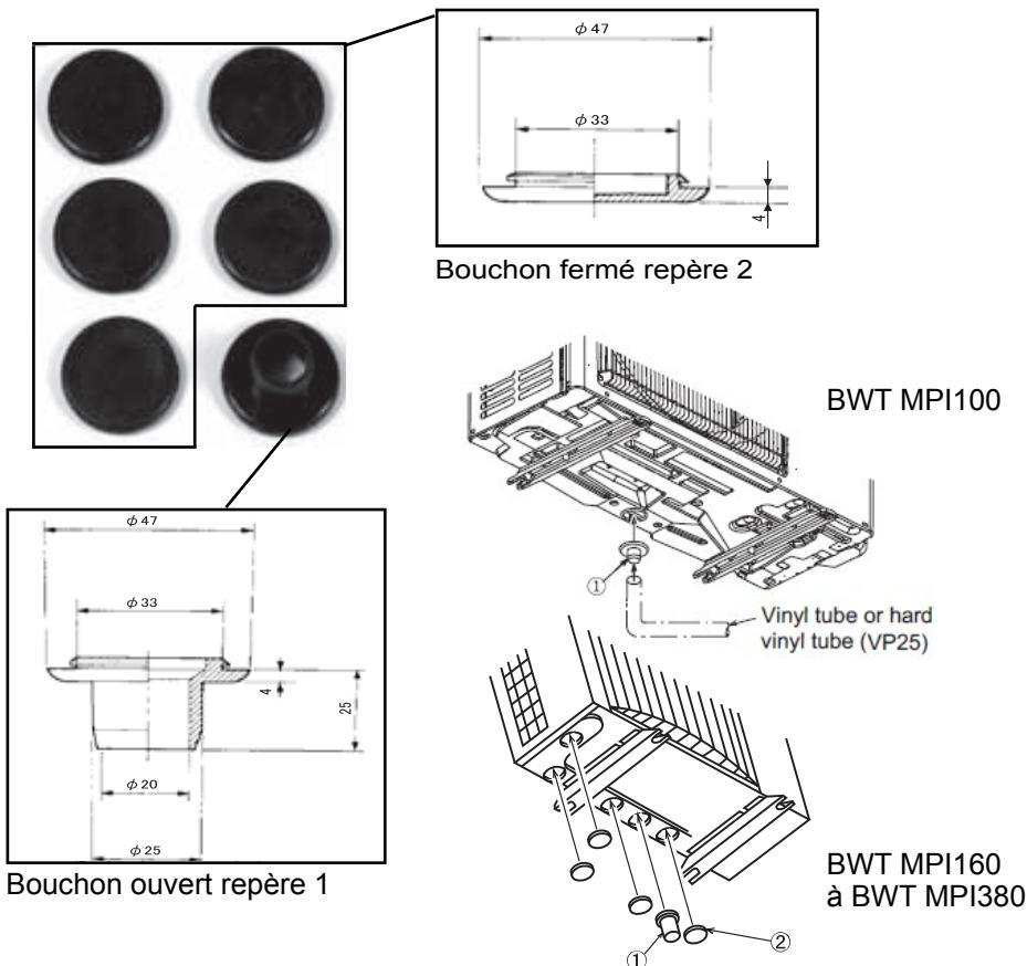
Les bouchons sont à insérer dans les trous du socle de la machine, voir figure ci-contre.
