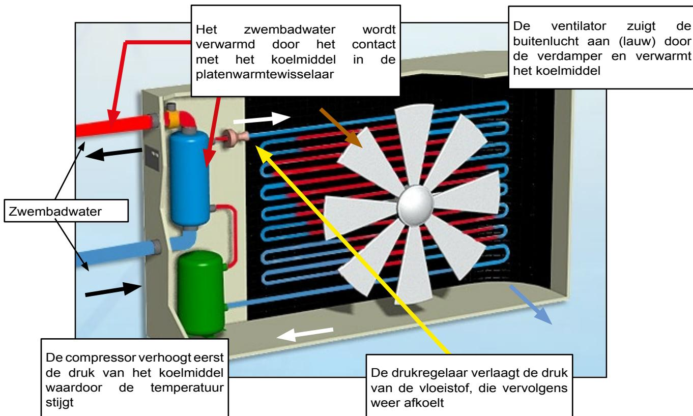
Als de temperatuur van de omgevingsslucht 15°C is, brengen de BWT-warmtepompen meer dan 4-6 keer de hoeveelheid elektriciteit over aan het zwembadwater die nodig is om te werken (compressor verbruikt 90% van deze energie): deze apparaten hebben een rendement (of COP = Coefficient Of Performance) van 4-6.
