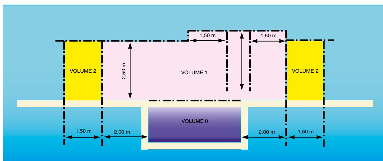
Volume 0: PELV-voeding \* (beveiliging extra lage spanning) < 12 V AC of 30 V DC + vloeistofbestendig IPX8-materiaal.
