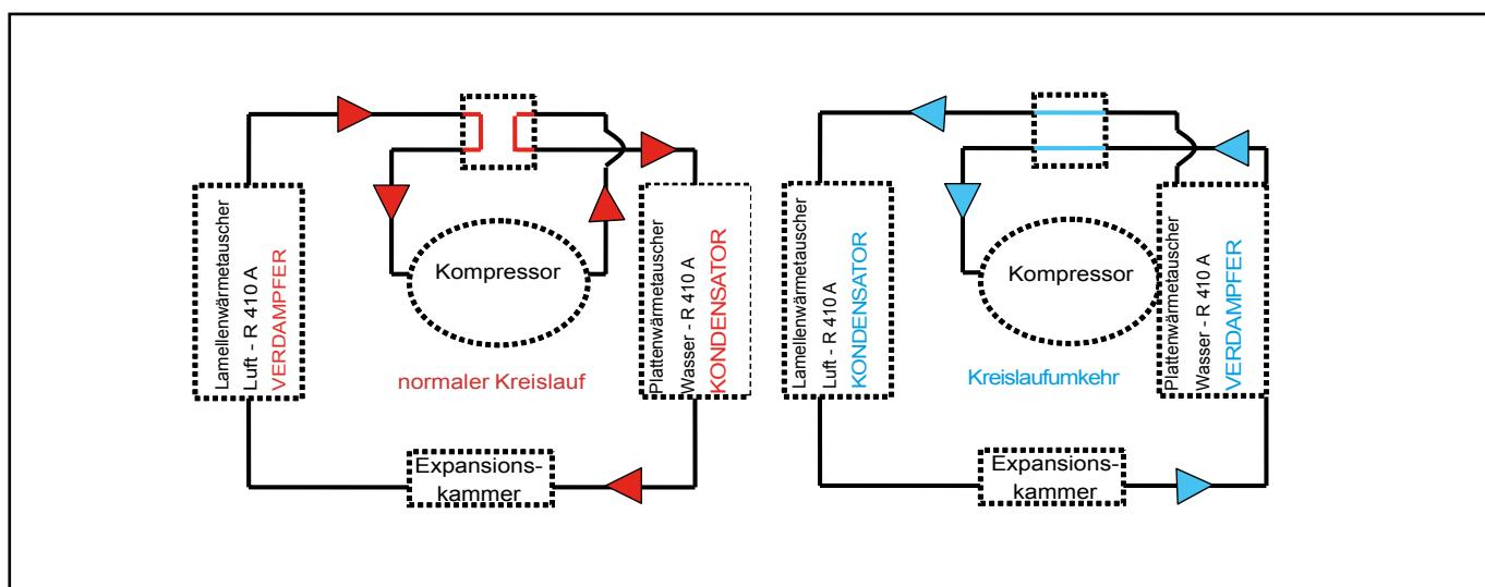
Die Rollen von Verdampfer und Kondensator sind vertauscht: Die Flüssigkeit leitet dem Lamellenwärmetauscher Wärmeeinheiten zu, um das Eis zum Schmelzen zu bringen. Im Abtau-Modus bleibt der Ventilator ausgeschaltet. Steigt die vom Sensor gemessene Temperatur wieder an, so ist der Abtau-Modus beendet und das 4-Wege-Ventil schaltet in den normalen Kreislauf zurück.
