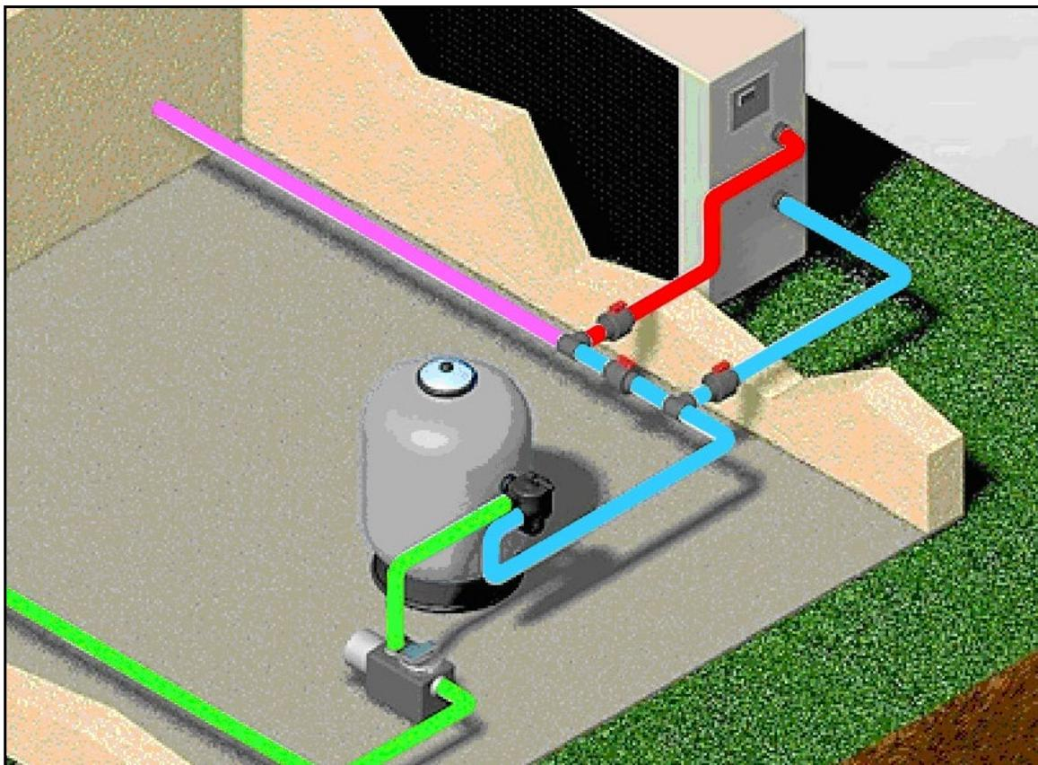
De buizen, kleppen en verbindingen moeten vervaardigd zijn van verlijmbaar PVC (10 bar) met een diameter van 50mm. **Laat goed drogen voordat de verlijmde verbindingen in contact komen met water.**
