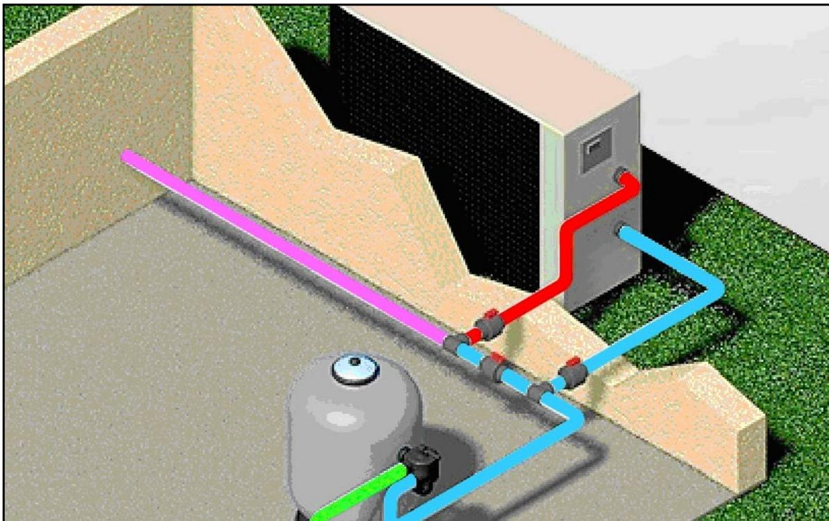
Les canalisations, vannes et raccords du by-pass doivent être en **PVC pression (10 bars)** en diamètre 50 à coller. **Bien laisser sécher les collages avant mise en eau**
