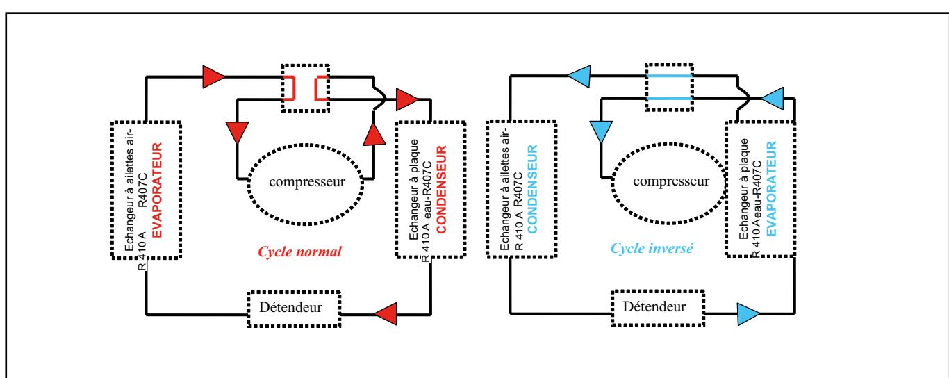
L'évaporateur et le condenseur inversent leurs rôles : le fluide apporte des calories au niveau de l'échangeur à ailettes pour faire fondre le givre. Pendant le dégivrage, le ventilateur reste à l'arrêt. Lorsque la température détectée par la sonde remonte, le dégivrage est terminée et la vanne 4 voies rétablit le cycle normal.
