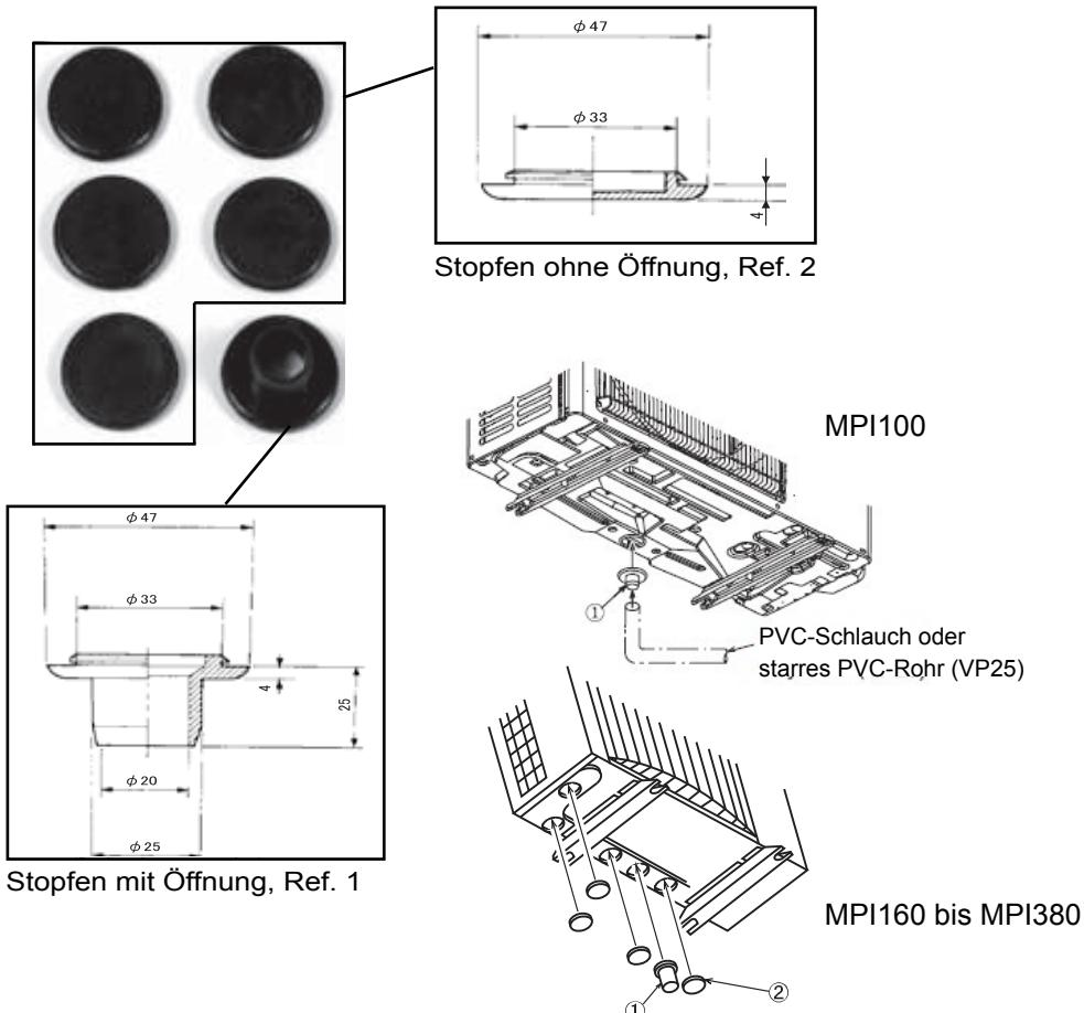
Die Stopfen sind gemäß Abb. in die Löcher am unteren Ende des Geräts zu stecken.
