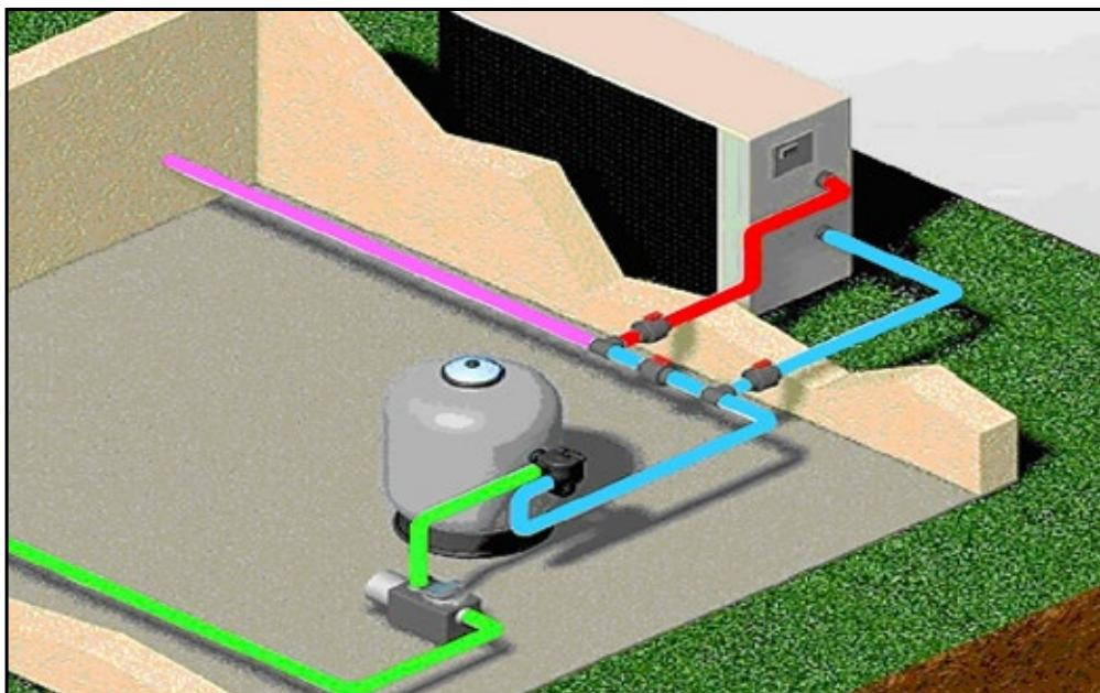
Die Leitungen, Kugelhähne und Anschlüsse, aus denen die Bypass-Verbindung besteht, sollten aus Hochdruck-(10 bar) PVC, Durchm. 50, und geklebt sein. Der Kleber muss vollkommen getrocknet sein, bevor Sie Wasser durch das Gerät laufen lassen.
