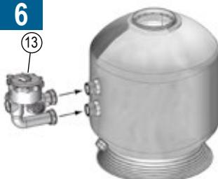
Montage des Mehrwege-Ventils. Montieren Sie zuerst die untere und dann die obere Mauerdurchführung. Ziehen Sie die Muttern vorsichtig an.
