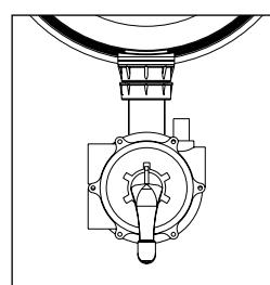
**FILTERN :** Normale Stellung des Ventils: Das Wasser fließt von oben nach unten durch den Filter und wieder in das Becken.
