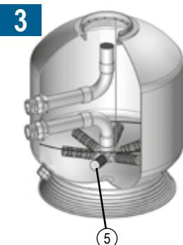
Füllen Sie den Tank bis 5 cm oberhalb der Ansaugröhren (5) mit Wasser.
