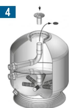
Verser en premier la charge de gravier, puis celle de sable avec précaution afin d'éviter de casser les crépines. Retirer le scotch du tube collecteur et remettre en place le diffuseur.
