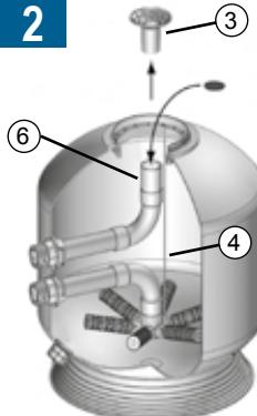
Entfernen Sie den oberen Verteiler (3). Achten Sie dabei auf die automatische Filterentlüftung (4). Decken Sie das Sammelrohr (6) mit einem Klebestreifen ab.
