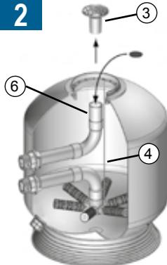
Enlever le diffuseur supérieur (3), en faisant attention au tube de purge automatique (4). Placer un scotch sur le tube collecteur (6).
