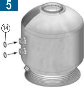
Mettre en place les joints toriques dans les gorges des traversées de paroi. Garnir le filetage du manomètre de 4 tours de ruban Téflon et visser celui-ci sur la vanne multivoies à la place du bouchon.
