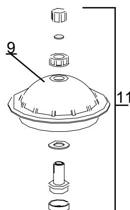
Positionieren Sie die obere Filterentlüftung auf dem Deckel.
