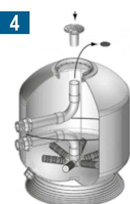
Füllen Sie vorsichtig zuerst den Kies und dann den Sand in den Filterbehälter, ohne dabei die Ansaugrohre zu beschädigen. Entfernen Sie den Verschluss vom Sammelrohr und setzen Sie den Verteiler wieder ein.
