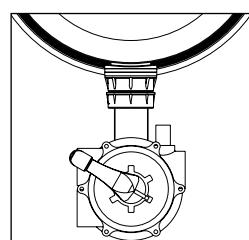
**GESCHLOSSEN :** Keine Wasserzirkulation möglich. Achten Sie darauf, dass die Pumpe in dieser Ventilstellung immer ausgeschaltet ist.
