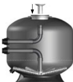
Verser la charge de sable (granulométrie 0.6/1.25) avec précaution afin d'éviter de casser les crépines. Retirer l'obturateur du tube collecteur et remettre en place le diffuseur supérieur.
