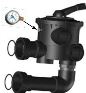
Führen Sie die Dichtungsringe in den Kragen der Mauerdurchführungen. Umwickeln Sie das Gewinde des Manometers viermal mit Teflonband und schrauben Sie es anstelle des Stopfen in das Mehrwegeventil.
