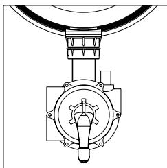
**FILTERN :** Normale Stellung des Ventils: Das Wasser fließt von oben nach unten durch den Filter und wieder in das Becken.
