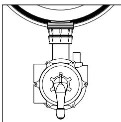
**FILTRACIÓN :** Posición normal de la válvula: El agua de la bomba pasa por el filtro de arriba a abajo y vuelve a la piscina.
