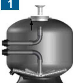
PTYHON 920 : Enlever le diffuseur supérieur (3), en faisant attention au tube de purge automatique (4). Placer l'obturateur sur le tube collecteur (6).
