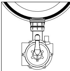
**RÜCKSPÜLUNG :** Das von der Pumpe kommende Wasser fließt von unten nach oben durch den Filter. Beim Abfließen werden alle, vom Filter aufgefangenden Schmutzpartikel mit ausgeschwemmt.
