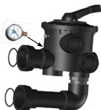
Inserte las juntas tóricas a los cuellos de los pasamuros. Aplicar 4 veces cinta de téflon a la rosca del manómetro y atornílelo a la válvula selectora en lugar del tapón.
