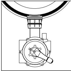
**NACHSPÜLEN :** Das von der Pumpe kommende Wasser fließt von oben nach unten durch den Filter und fließt durch den Ablauf ab.
