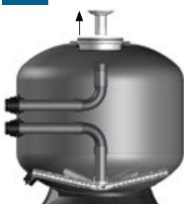
PTYTHON 920 : Entfernen Sie den oberen Verteiler (3). Achten Sie dabei auf die automatische Filterentlüftung (4). Setzen Sie den Verschluss auf das Sammelrohr (6).
