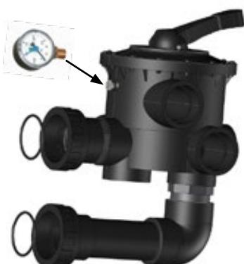
Mettre en place la vanne multivoies : placer d'abord la traversée basse puis la traversée haute. Serrer les écrous modérément.
