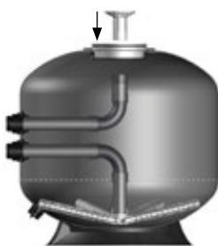
Llenar cuidadosamente la carga de arena (granulometría 0.6/1.25) sin romper las colectores. Quitar el obturador del tubo de colector y volver a poner el difusor superior.
