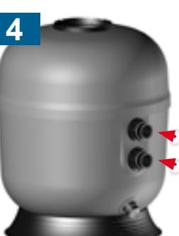
Mettre en place les joints toriques dans les gorges des traversées de paroi.
