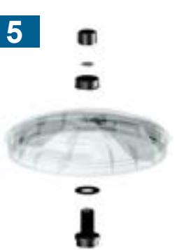
Mettre en place la purge haute sur le couvercle.
