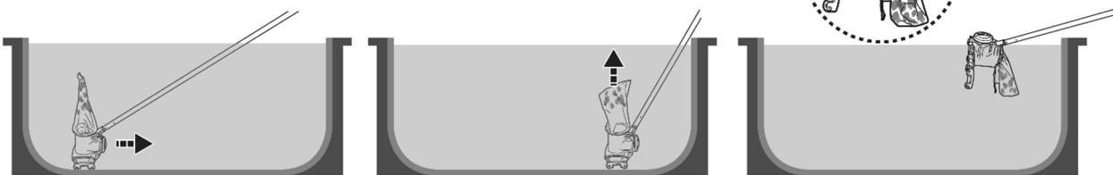
Assim que o aspirador de piscinas estiver fora da água, o propelente irá deixar de rodar em 2-3 segundos. A luz LED irá ficar azul. Quando o nível da bateria estiver fraco, a luz azul irá piscar.
