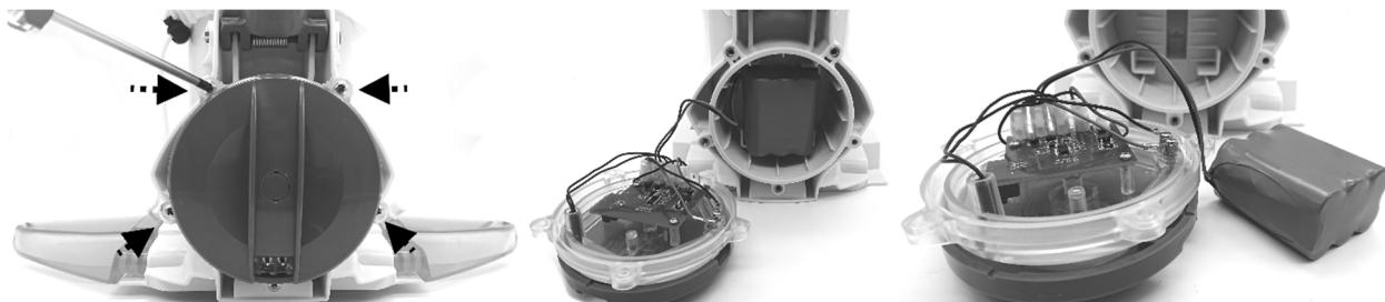
2. För att lossa batteriets anslutningstråd, tryck på kontaktens klämma och dra ut den. **ANMÄRKNING:** Linda omedelbart isoleringstejp runt kontakten för att undvika kortslutning orsakad av att de två anslutningsterminalerna kommer i kontakt med varandra.
