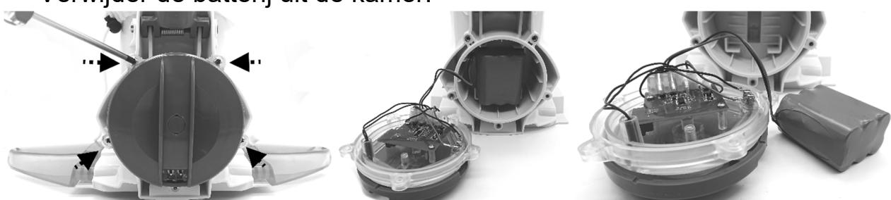
2. Om de batterijverbinding draad los te maken, drukt u op de clip van de connector om deze eruit te trekken. **OPMERKING:** Wikkel de connector onmiddellijk met isolatietape in om kortsluiting door het contact van beide draadaansluitingen te voorkomen.
