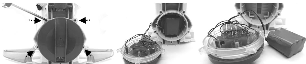
2. For å koble fra batteriledningen må du trykke på klipsen på koblingen for å dra den ut. MERKNAD: Pakk koblingen inn i isolasjonsteip øyeblikkelig, for å unngå kortslutning forårsaket av kontakt med begge ledningsterminalene.
