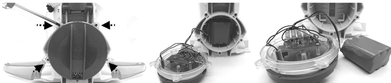
2. Для отсоединения провода подсоединения аккумулятора нажмите на зажим разъема провода и вытяните его. **ПРИМЕЧАНИЕ:** Немедленно оберните контакты изолентой, чтобы избежать короткого замыкания, вызванного контактом обеих клемм проводов.
