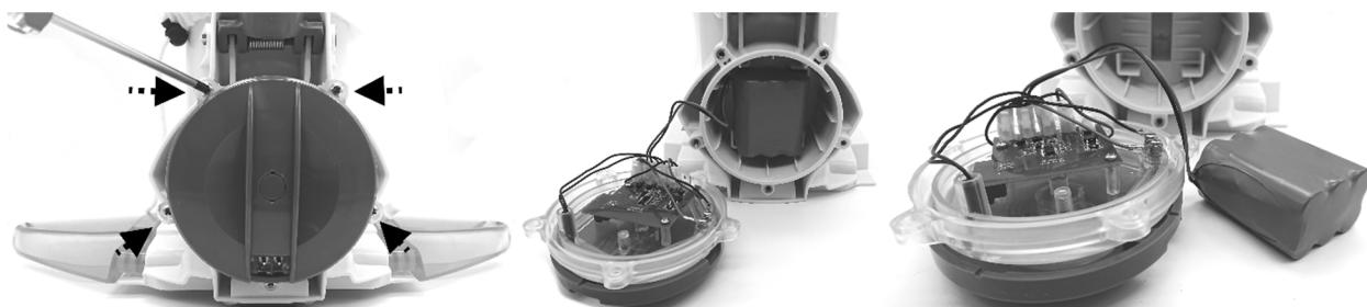
2. Para retirar o cabo de ligação da bateria, prima o clipe do conector para o puxar para fora. NOTA: Enrole o conector imediatamente com fita isoladora de modo a evitar qualquer curto-circuito causado pelo contacto de ambos os terminais de cabo.
