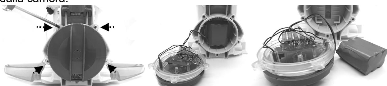
2. Per staccare il cavo di collegamento della batteria, premere sulla clip del connettore per estrarlo. NOTA: avvolgere immediatamente il connettore con nastro isolante per evitare cortocircuiti causati dal contatto di entrambi i terminali del filo.
