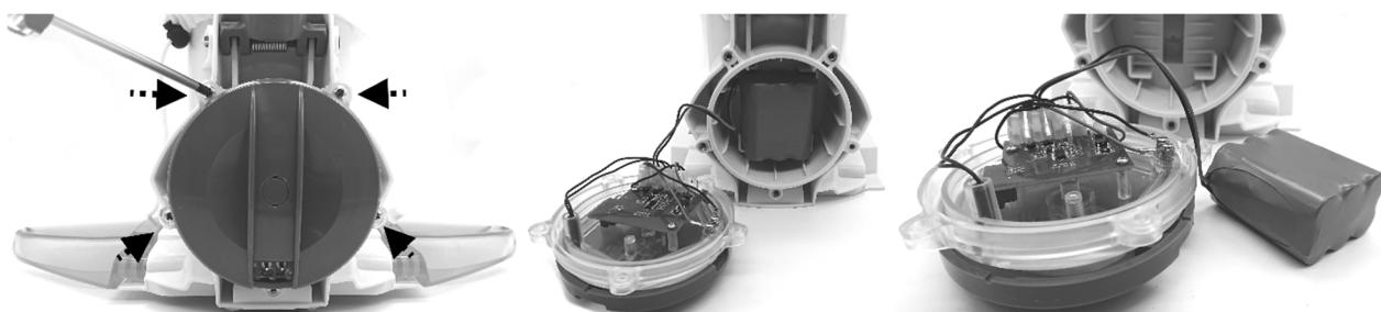
2. Para soltar el cable de conexión de la batería, presione el clip del conector y tire de él. NOTA: Envuelva el conector inmediatamente con cinta aislante para evitar que los terminales de ambos cables entren en contacto y se produzca un cortocircuito.
